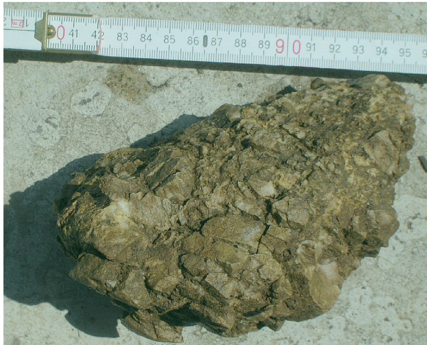
Abb. 17. Größeres fragmentiertes, verdrücktes aber dennoch zusammenhaltendes Quarziteröll. Der Druck bei der Einlagerung, nach der sich die Komponente nicht mehr merklich bewegt haben kann, muß erheblich gewesen sein, um die Druckfestigkeit des Quarzits (in der Größenordnung 100 - 300 MPa = 1 - 3 Kilobar) zu überschreiten.
