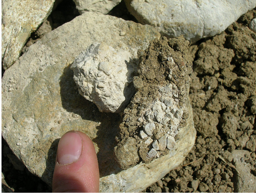
Abb. 16. Völlig zertrümmerte aber mehr oder weniger kohärente Kalksteinbrocken, der linke mit Mörtelgefüge.
