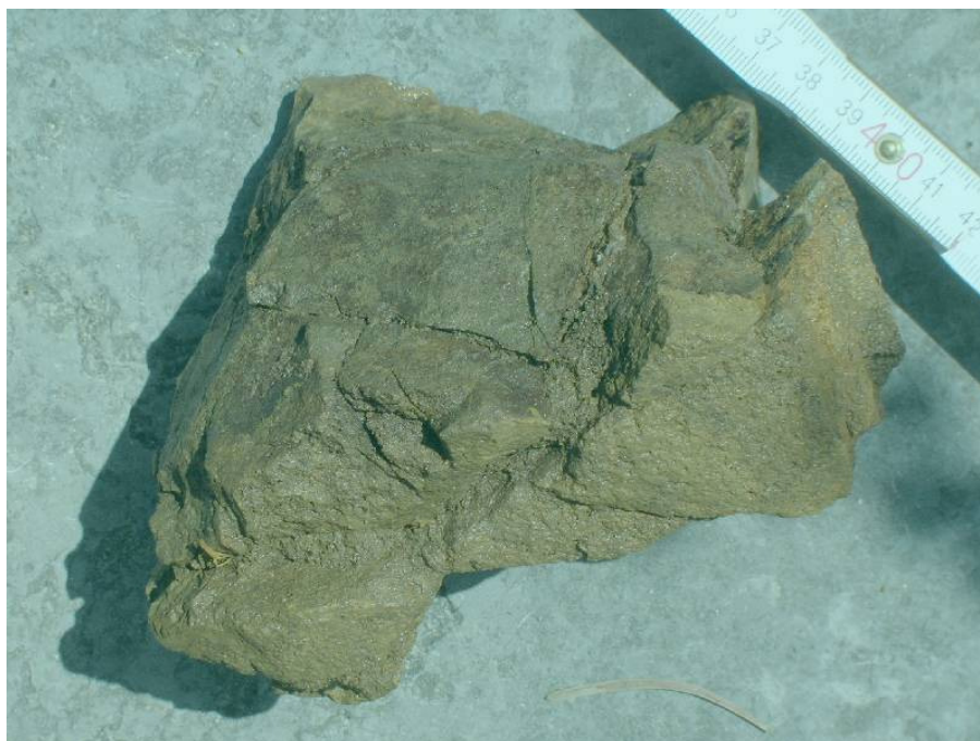
Abb. 12. Komponente B: Grobstückig fragmentierter, aber zusammenhaltender Quarzitbrocken.
