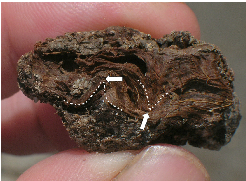
Abb. 28. Stark zusammengedrücktes Holzfragment mit Faltenbildung der Fasern. In geologischer Terminologie ausgedrückt, haben sich regelrechte Knickfalten gebildet (Pfeile). Fig. 28. Strongly compressed splint exhibiting folding of the wood fibers. Geologically speaking, virtual kink folds have formed (arrows).
